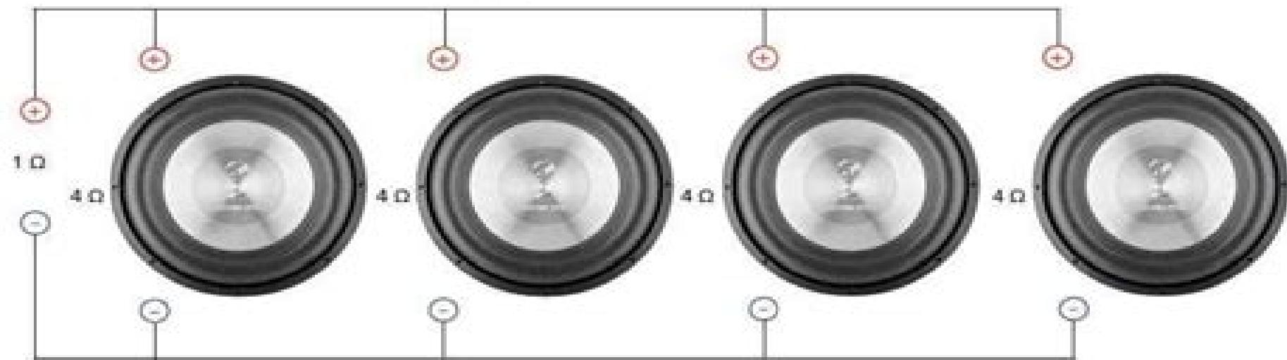
4 Ohm Einzelschwingspule / Single voice coil
