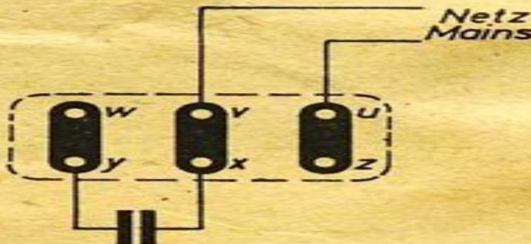
Anschluß des Drehstrommotors 220/380V mit  $\Delta$ -Schaltung
